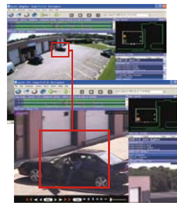
Gleiche Ansicht einer fest installierten Kamera und einer von AIRA 2005 vollautomatisch gesteuerten Domekamera.
